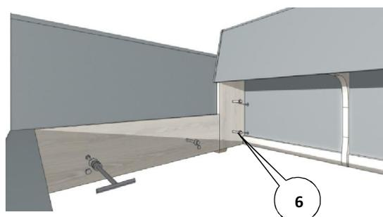
2. Раскрутить желтые проволочные фиксаторы, частично разложить механизм. Выкрутить нижние болты в коробе механизма на 10мм. **ОБЯЗАТЕЛЬНО ВДВОЁМ** поднять механизм и завести кронштейны в короб под небольшим углом.
