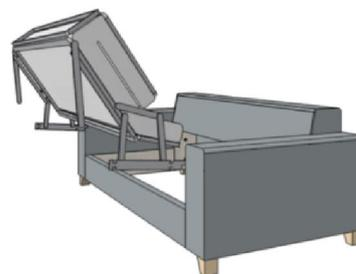
3. Надеть нижнее заднее отверстие кронштейна на задний нижний болт. Затем слегка поджимая кронштейны внутрь, опустить переднее нижнее монтажное отверстие на передний нижний болт. Сдвинуть механизм назад до упора, затянуть болты.
