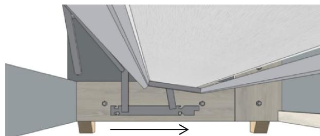
4. В процессе эксплуатации возможно ослабление соединений, следует периодически самостоятельно подтягивать болты и саморезы. Так-же по необходимости смазывать шарниры механизма подходящей смазкой типа «Литол».
