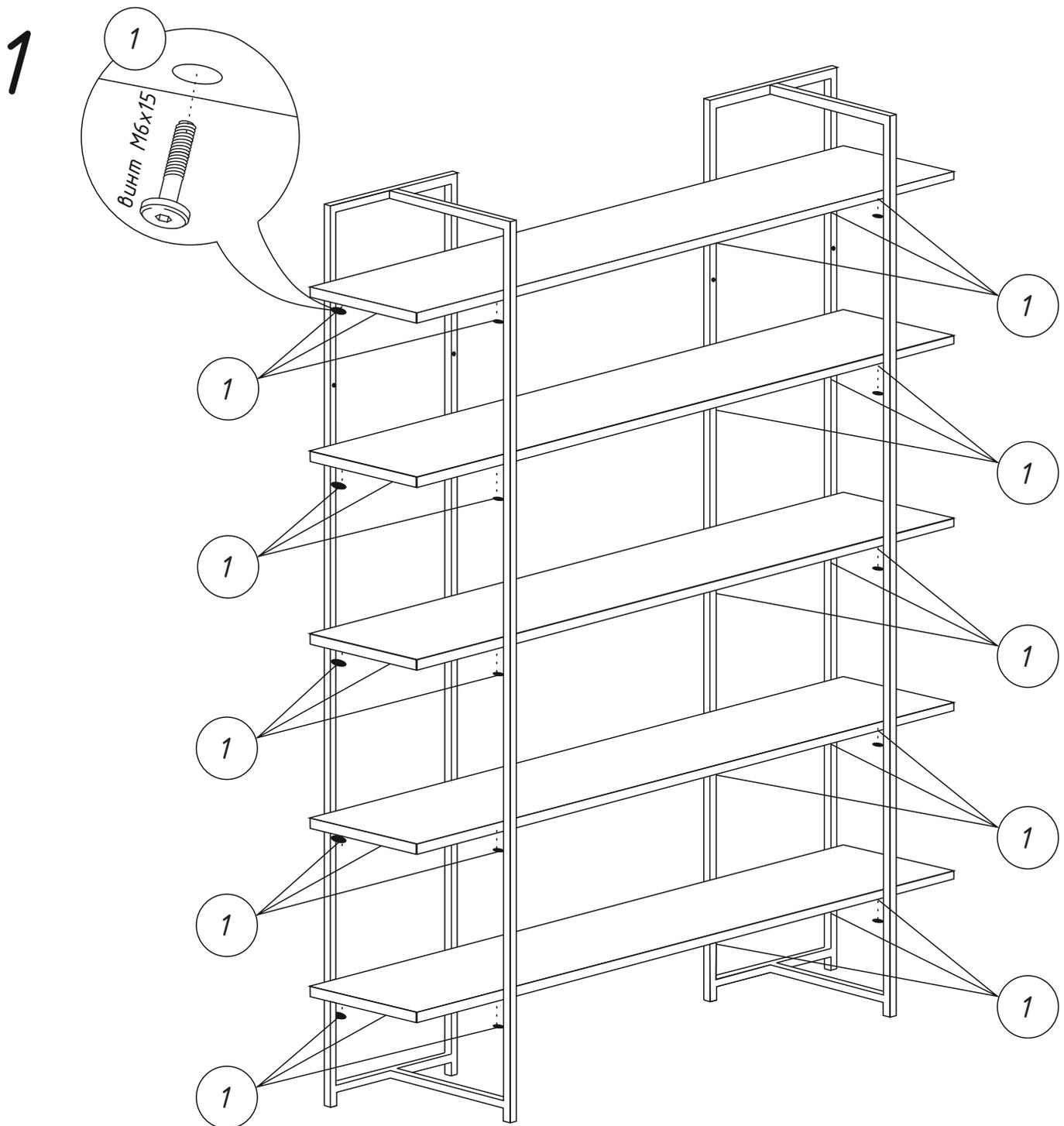
1. Винтами М6х15 соединить полки и опоры, выровняв детали по местам крепления.
