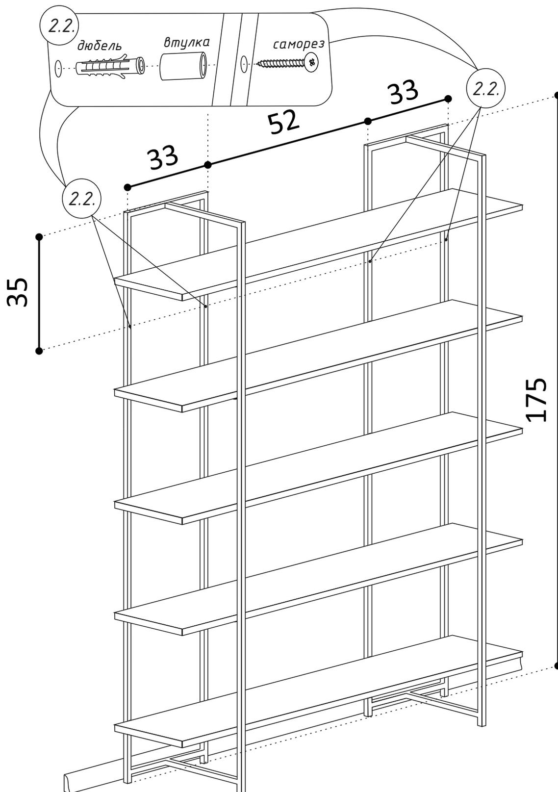
2.1. Установить стеллаж у стены, отметив карандашом места крепления, просверлить отверстия.
