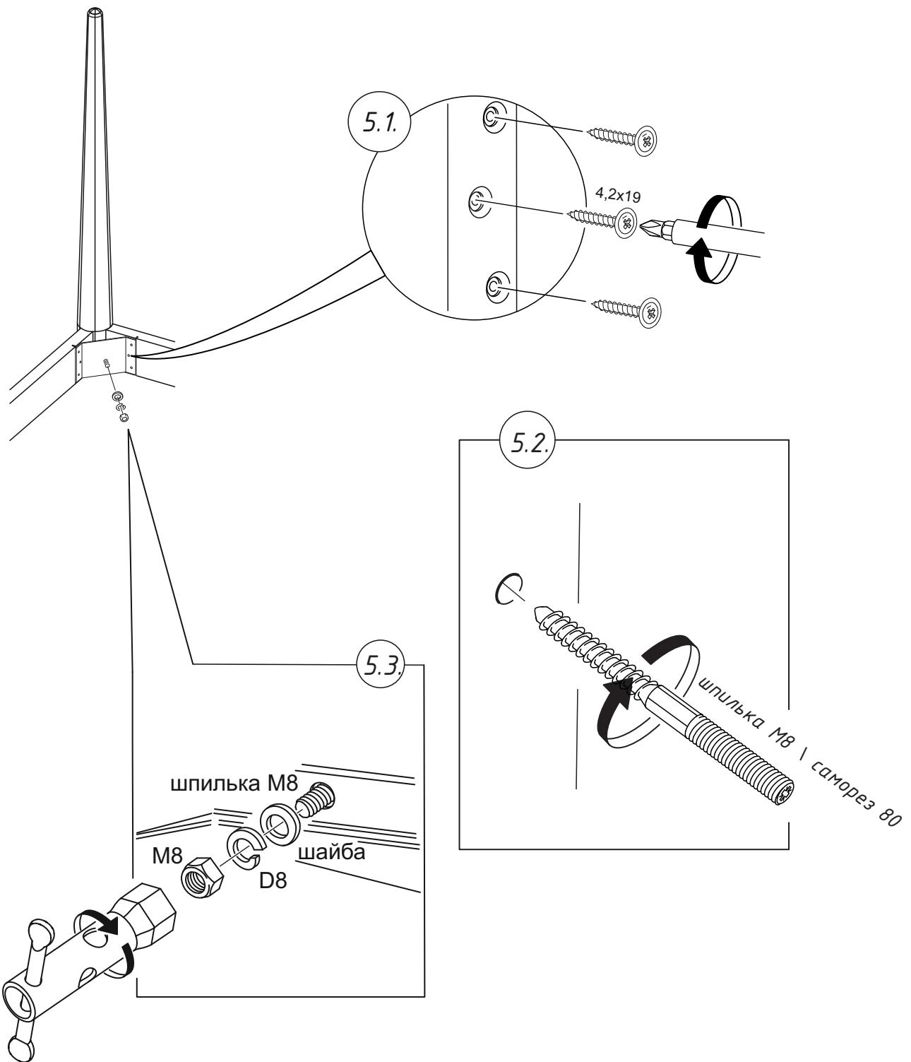
5.1. Зафиксировать «Уголок для крепления опоры» саморезами 4,2x19.
