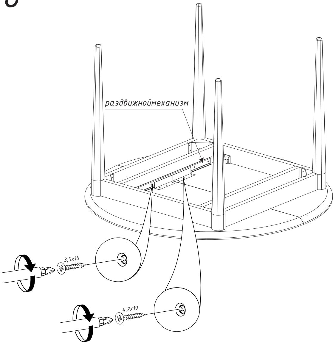
6.1. Положить столешницы на ровную не твердую (например, на ковёр, покрывало и т.п.) поверхность.
