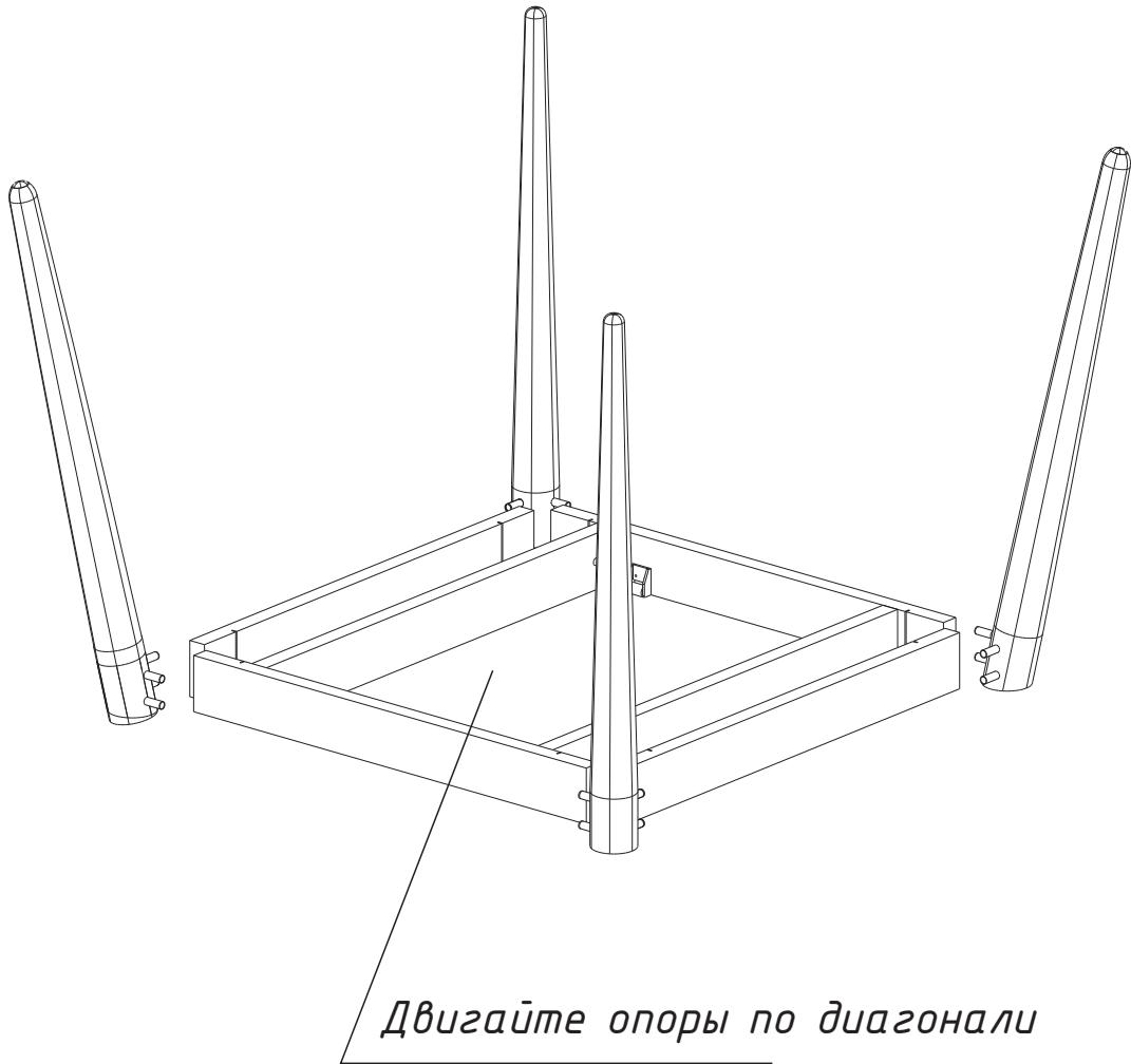
4.1. Оставив небольшой зазор между деталями, соединить опоры и поперечную царгу.
