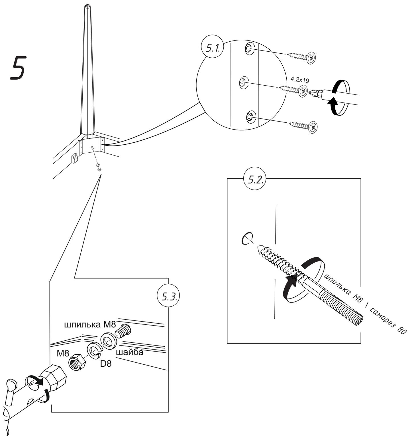
5.1. Зафиксировать «Уголок для крепления опоры саморезами 4,2x19.
