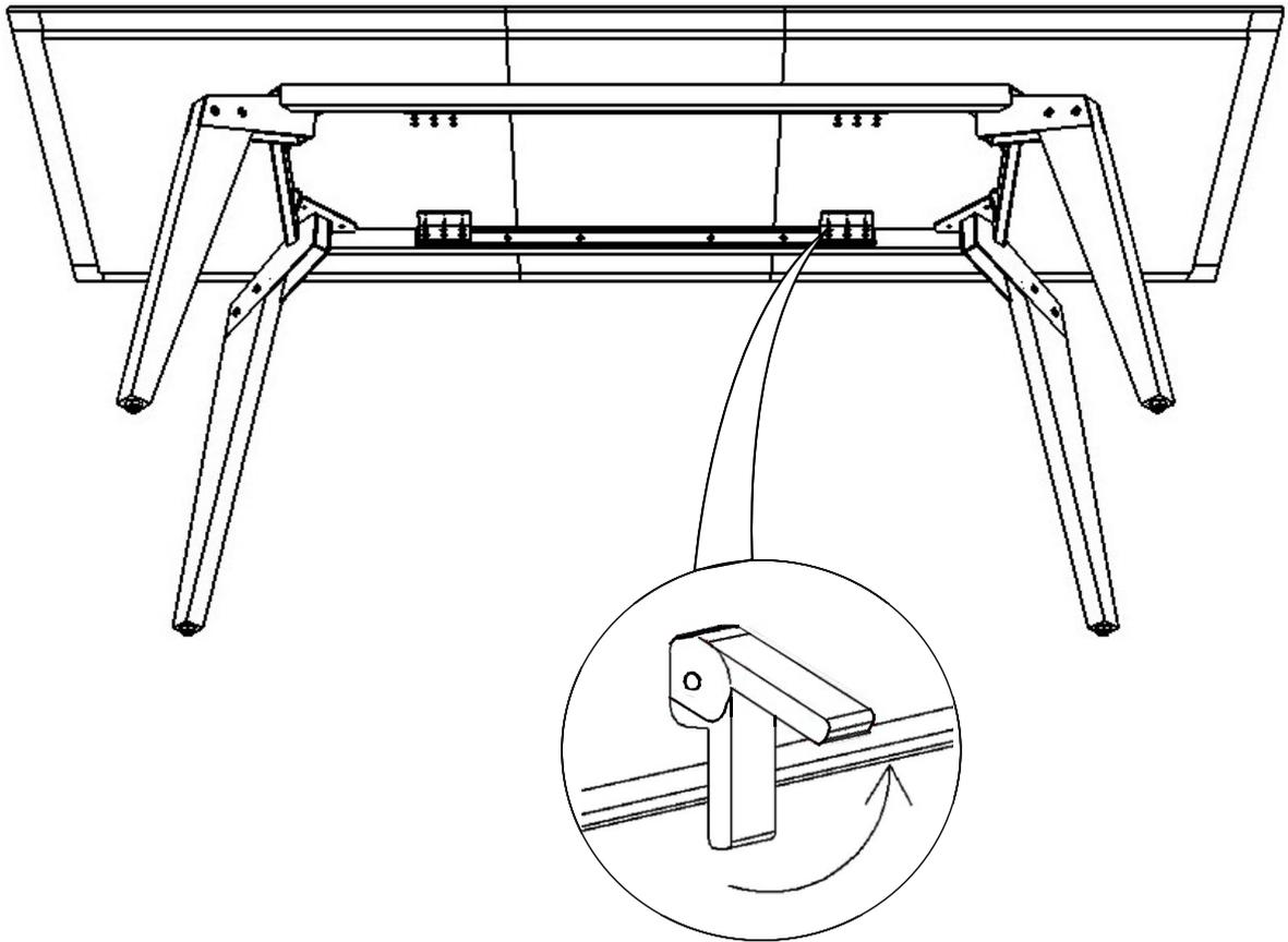
5.1. Для фиксации положения рычаг стопора поднять вверх.
