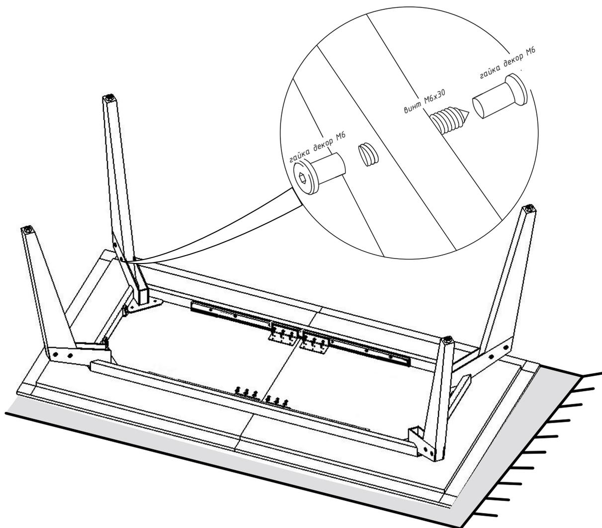
2.1. Установить опору между пластинами так, чтобы отверстия между ними совпадали.
