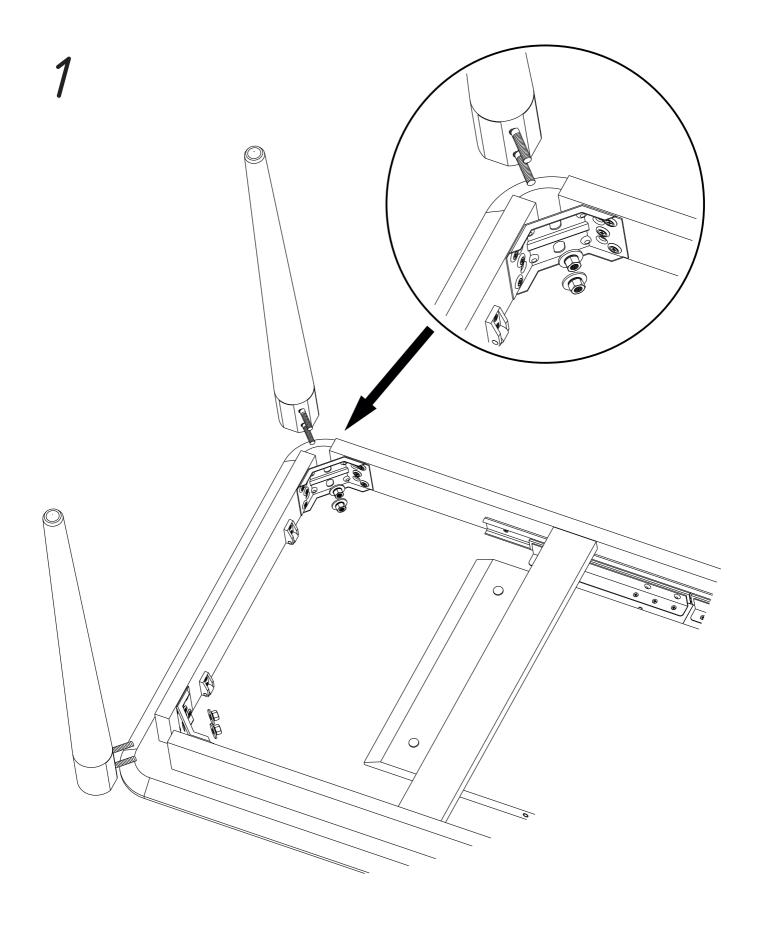
1.1. Притянуть опору гайкой М8.
