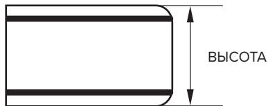
Аналогичным способом измеряется длина и ширина матраса. ГОСТ на изготовления матраса допускает отклонения от габаритов +/-20 мм. Ширина окантовочной ленты при этом в расчет не принимается.
